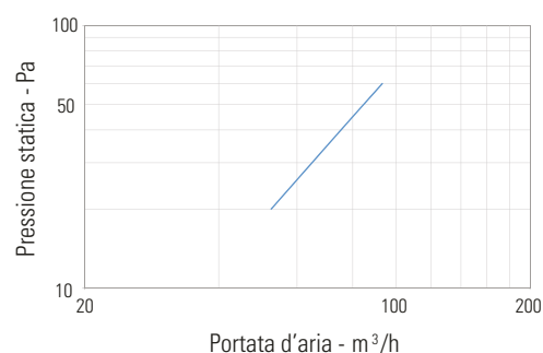
Griglia tonda con rete per immissione / espulsione aria dall'abitazione Round grill with net for air intake / extraction from the home
